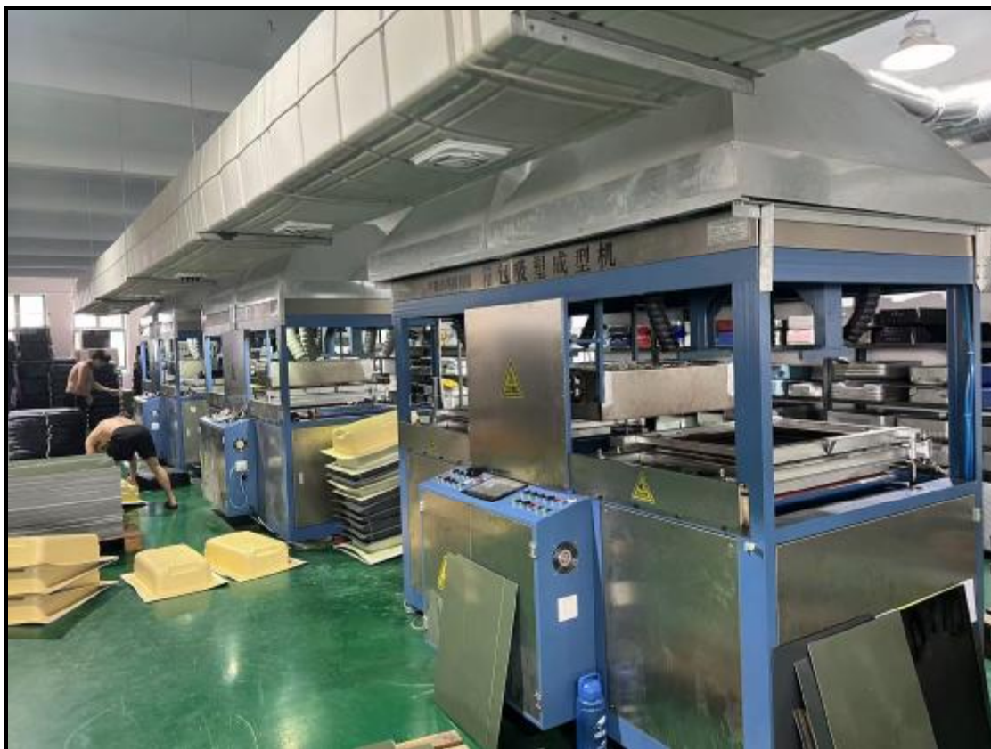
图 4-4 废气收集设施照片（吸塑废气）
