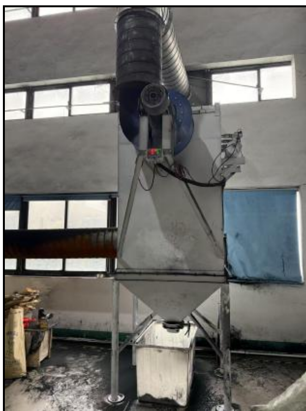
图 4-6 废气治理设施照片（破碎粉尘）
