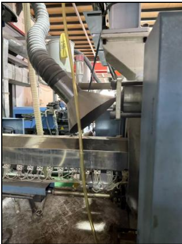
图 4-4 废气收集设施照片
